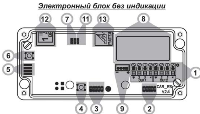
Рисунок 1.9 – Расположение основных элементов электронного блока (Окончание)
